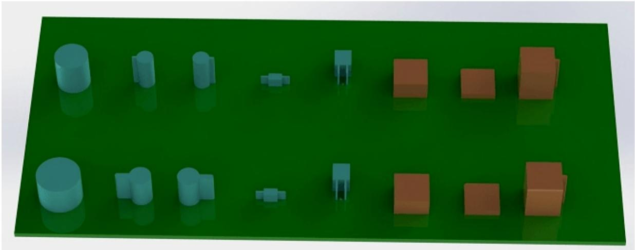
Figura 4: Contorni di esempio generati dai programmi idfcyl e idfrect e renderizzati da SolidWorks.
