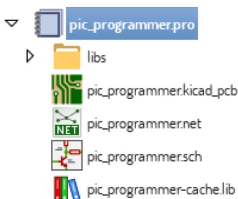
Двойной щелчок по файлу схемы запускает редактор электрических схем, который, в данном случае, открывает файл **pic\_programmer.sch**.
