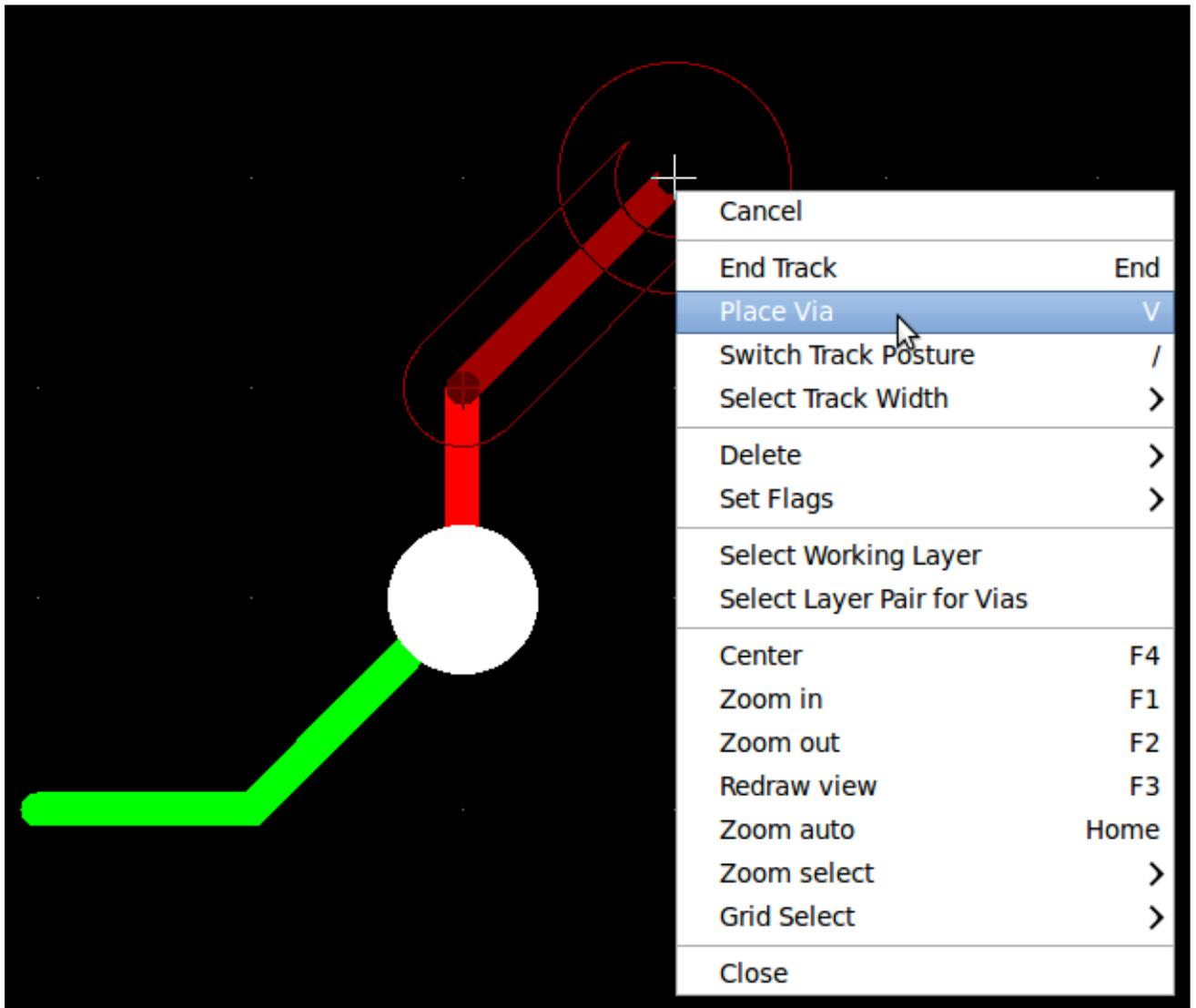
22. Cuando quiera inspeccionar una pista concreta puede hacer clic en el icono *resaltar Nodo*
