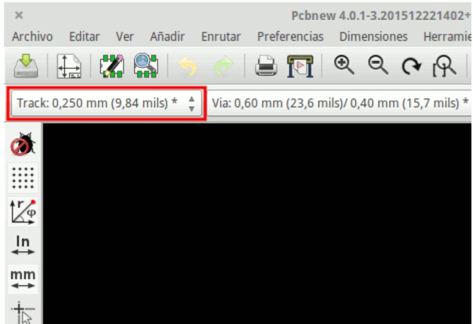
16. Si desea agregar más anchos de pistas a seleccionar, vaya a: **Reglas de Diseño** → **Reglas de Diseño** → **Reglas de Diseño Global** y en la parte inferior derecha de esta ventana puede añadir cualquier otra anchura que desee tener a su disposición. A continuación, puede elegir el ancho de la pista en el menú desplegable, durante el diseño de la placa. Vea el siguiente ejemplo (medidas en pulgadas).
