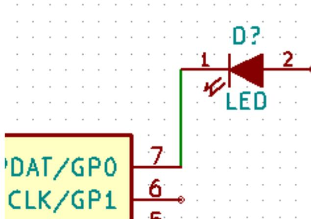
33. Repita este proceso y conecte el resto de componentes como se muestra a continuación. Para terminar un hilo simplemente haga doble clic. Al conectar los símbolos VCC y GND, el hilo debe tocar la parte inferior del símbolo VCC y el centro de la parte superior del símbolo GND. Vea la siguiente imagen.
