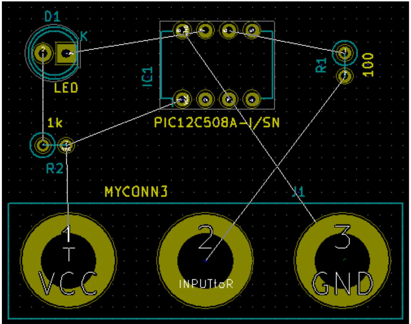
10. Si el ratsnest desaparece o la pantalla se enmaraña, haga clic derecho y haga clic en *Redibujar vista*. Note como existe una conexión de un pin de la resistencia de 100 ohmios al pin 6 del componente PIC. Este es el resultado del método de etiquetado utilizado para conectar los pines. Las etiquetas se prefieren a menudo a los hilos reales porque hacen que el esquema resulte mucho menos desordenado.
