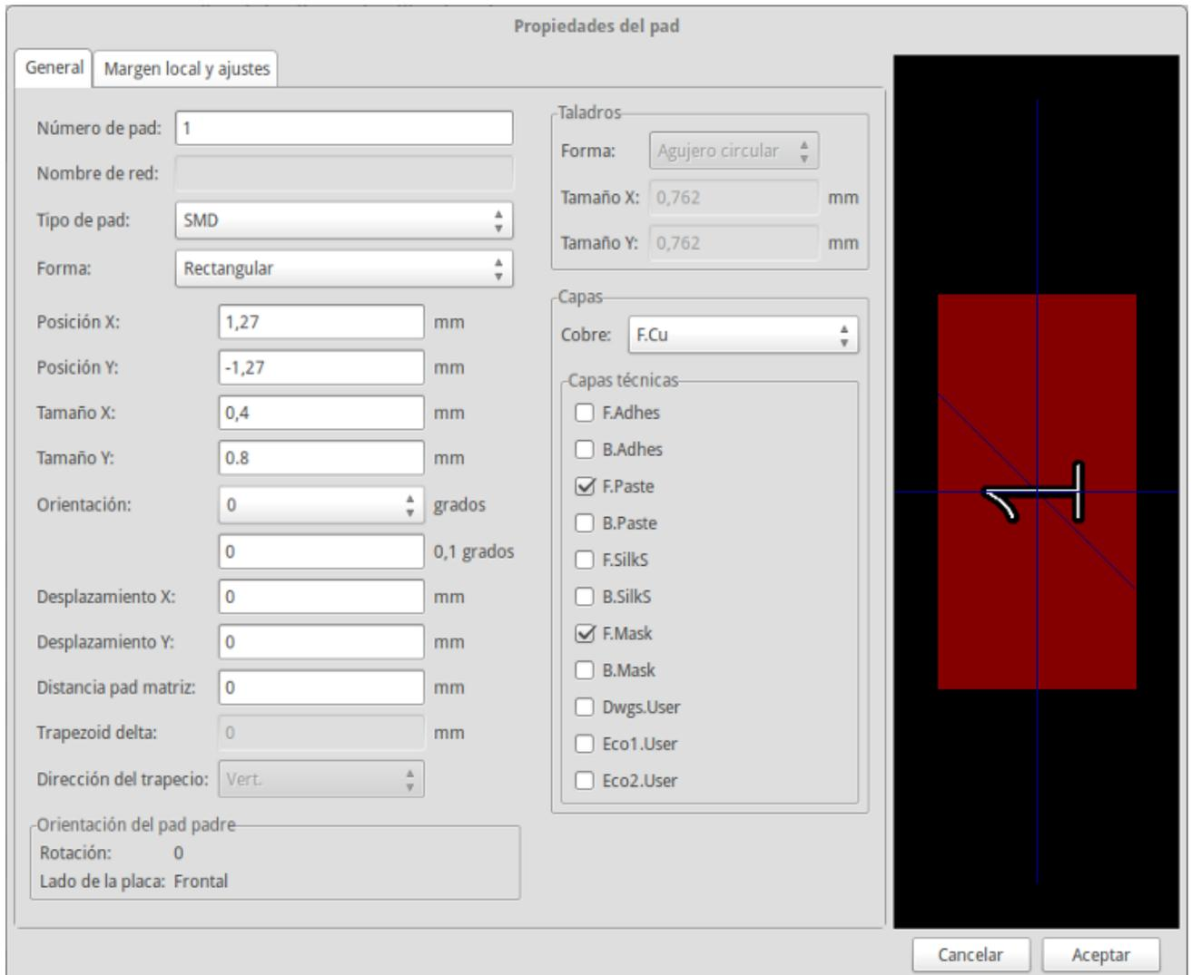
5. Ajuste el *Número de Pad* a 1, *Forma del Pad* a *Rect*, *Tipo de Pad* a *SMD*, *Tamaño X* a 0.4 y *Tamaño Y* a 0.8. Haga clic en *Aceptar*. Haga clic de nuevo en *Añadir Pads* y coloque dos pads más.
