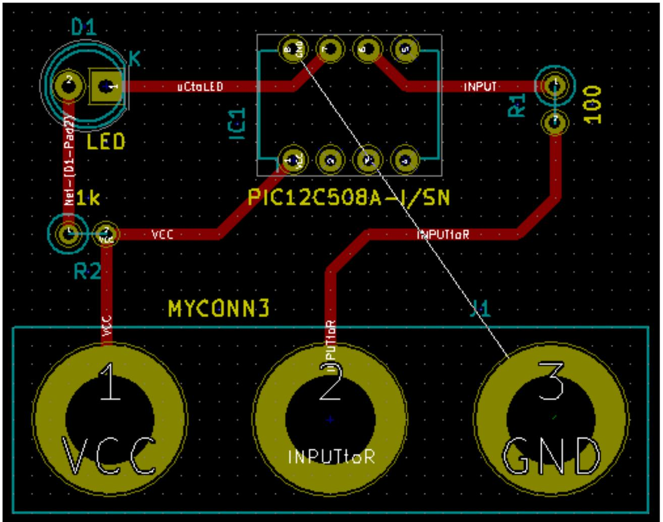
20. Dessinons maintenant une piste sur l'autre face de cuivre du PCB. Sélectionnez *B.Cu* dans le menu déroulant de la barre d'outils du haut. Cliquez sur l'icône *ajouter pistes et vias*. Dessinez une piste entre la broche 3 de J1 et la broche 8 de U1. Cette connexion n'est pas nécessaire puisque que nous pourrions la réaliser avec le plan de masse. Observez le changement de couleur de la piste.
