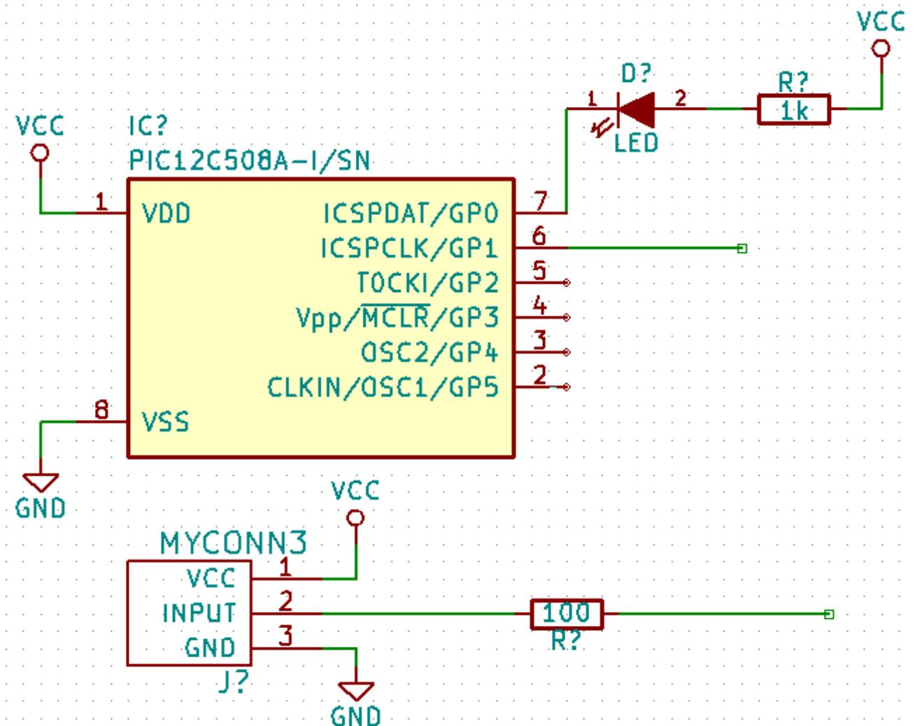
34. Voyons maintenant une autre façon de réaliser une connexion en utilisant des étiquettes(labels). Cliquez sur l'icône *Placer un nom de net - label local*
